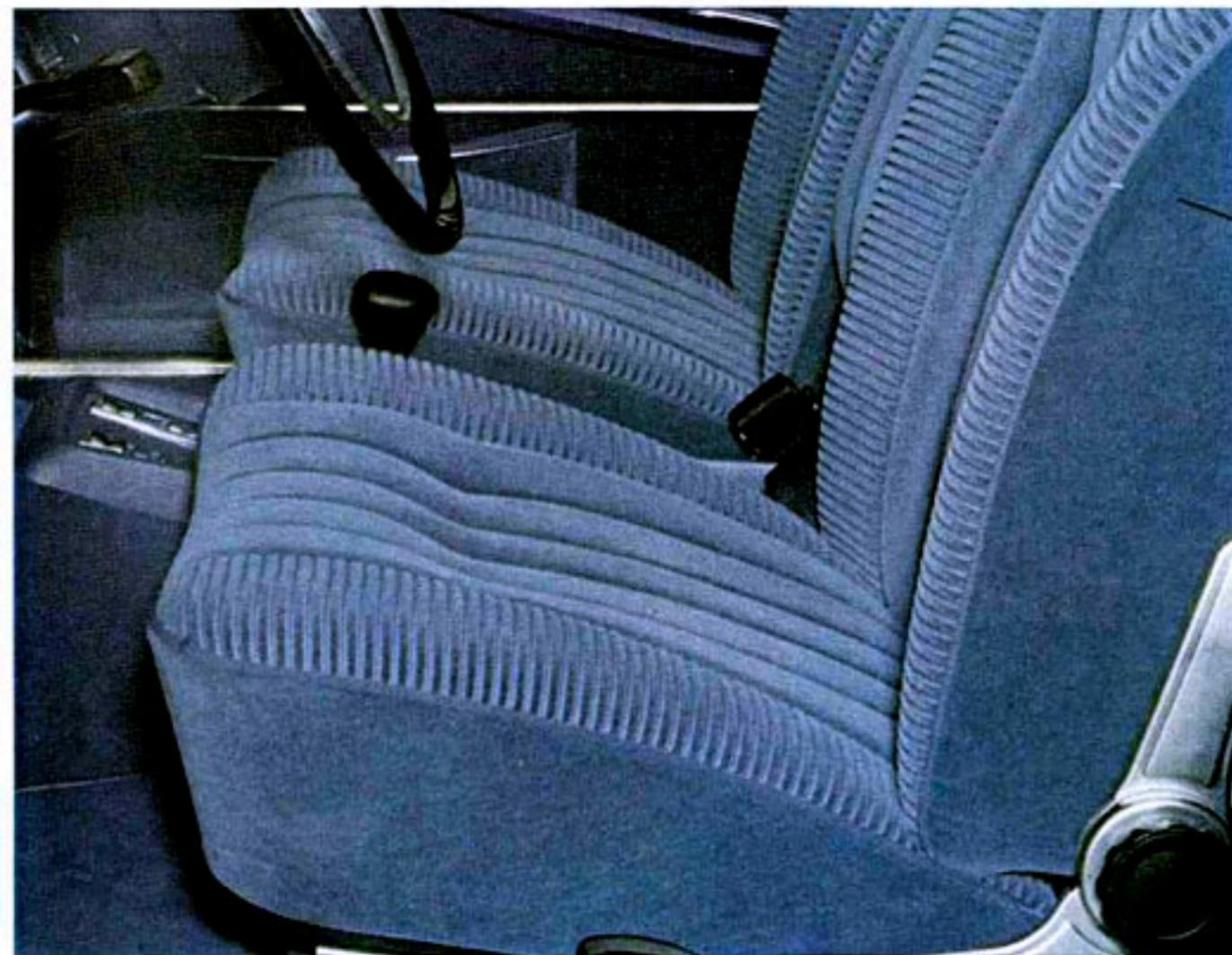
Körpergerecht geformte Sitze mit stufenlos verstellbarer Rückenlehne (Ruhesitzeinrichtung); Der Fahrersitz ist auch in der Höhe verstellbar.
